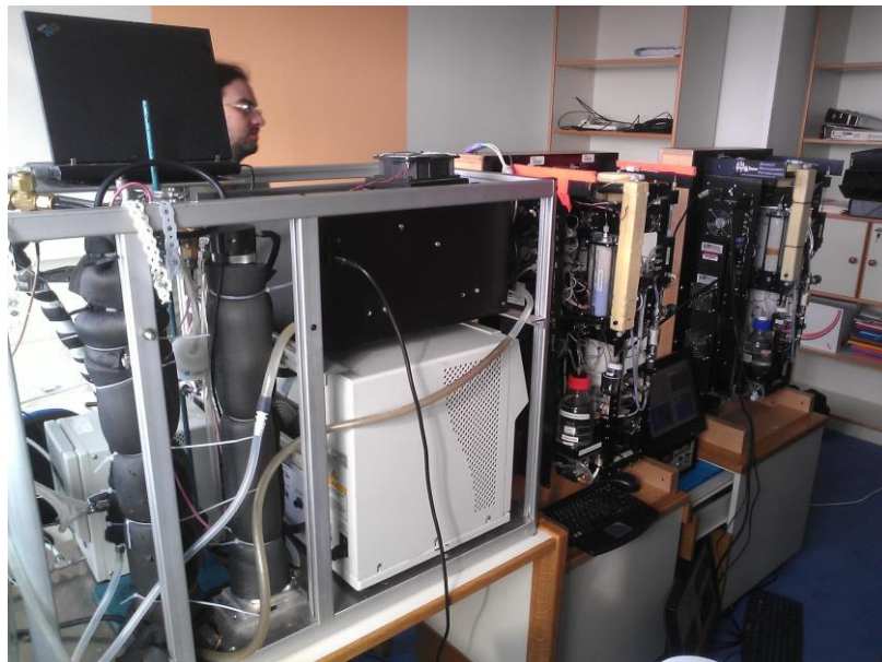
Εικόνα 2: Φωτογραφία του συστήματος HTDMA σε μετρήσεις πεδίου. Το HTDMA (αριστερά) συνδυάστηκε με ένα καταμετρητή πυρήνων συμπύκνωσης σύννεφων (Cloud Condensation Nuclei counter; CCNC, στο κέντρο) με σκοπό την μέτρηση της υγροσκοπικότητας λεπτόκοκκων και υπέρ-λεπτόκοκκων αιωρούμενων σωματιδίων σε συνθήκες υπό- και υπέρ-κορεσμού.
