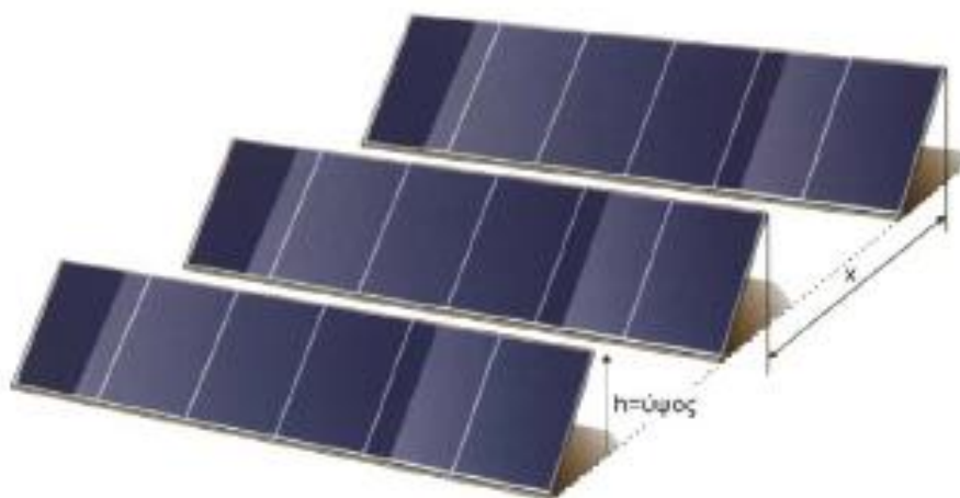
Σχήμα 1.24: Ελάχιστη απόσταση Φ/Β πλαισίων λόγω σκίασης
