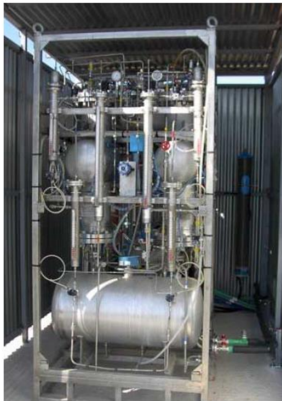
Σχήμα 3.9: Μονάδα ηλεκτρόλυσης 25 kW
