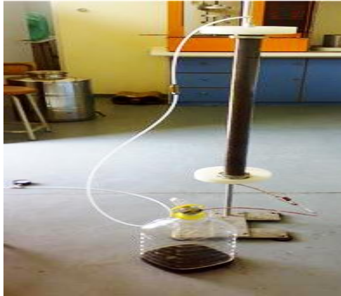
Σχήμα 3. Καθαρισμός εκχυλίσματος αντιοξειδωτικού ελιάς με χρήση στήλης βιομηχανικής χρωματογραφίας και εκλεκτική ρητίνη συγκράτησης πολυφαινολών τύπου XAD4.
