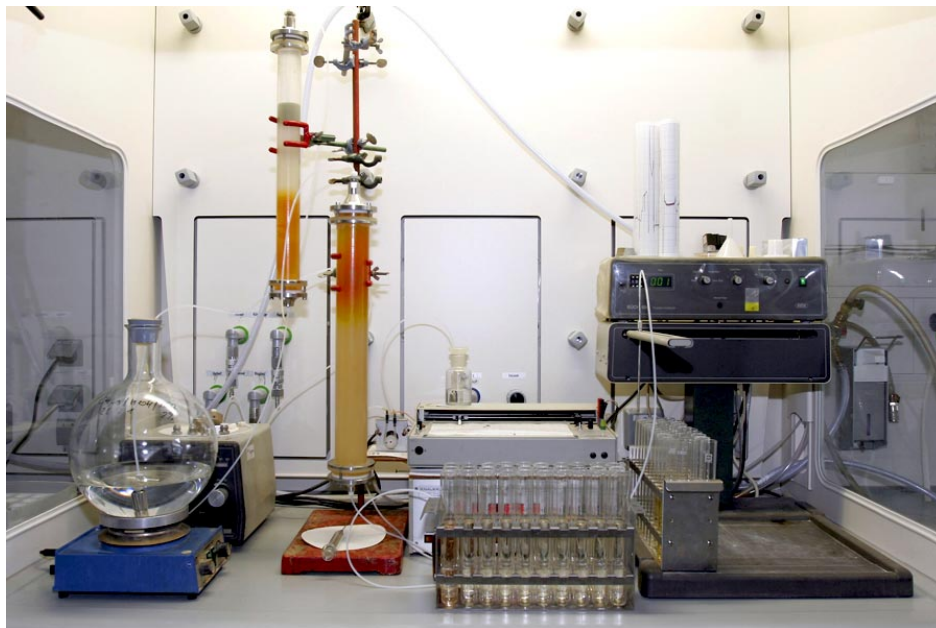
Σχήμα 4. Βιομηχανική εγκατάσταση για καθαρισμό εκχυλισμάτων και διαχωρισμό βιοδραστικών ουσιών με χρήση βιομηχανικής χρωματογραφίας μακρο-πορωδών ρητινών
